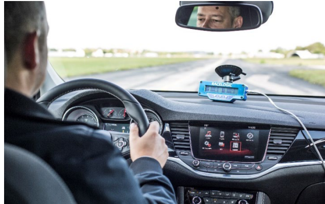
Fahrleistungsmessungen mittels GPS-Messsystem
