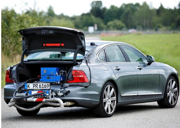
Der ADAC besitzt eine PEMS-Anlage der Firma Sensors „SEMTECH LDV“. Die RDE-Messungen umfassen derzeit die Schadstoffe Kohlenmonoxid CO, Stickoxide NOx und die Partikelzahl PN.
