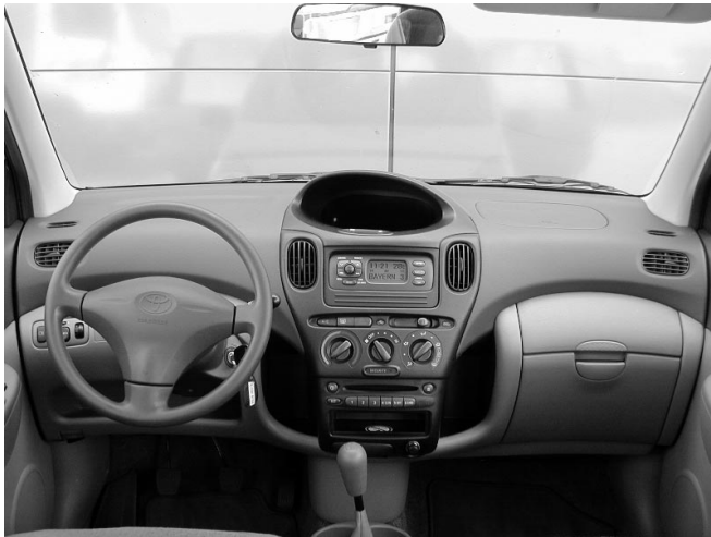
Äußerst gewöhnungsbedürftig sind die ungünstig in der Mitte angeordneten, schlecht ablesbaren Instrumente.
