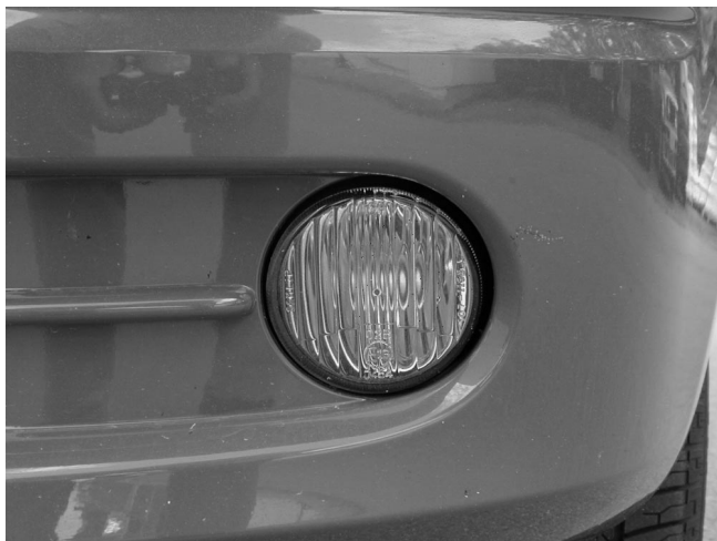
Die Nebelscheinwerfer sind bruchgefährdet im Stoßfänger untergebracht.
