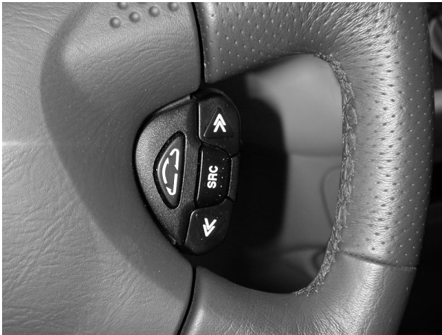
Die Fernbedienung des Radios sowie der Umluftschalter sind im Lenkrad integriert.
