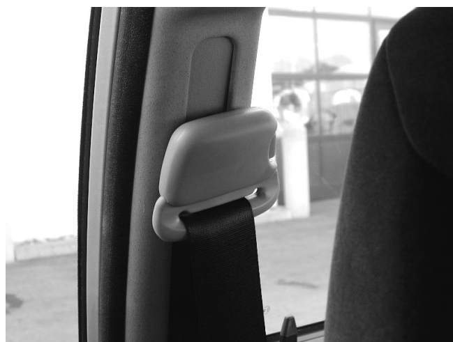
Kantige Umlenkbeschläge bedrohen die Köpfe der Frontpassagiere bei einem Seitencrash.
