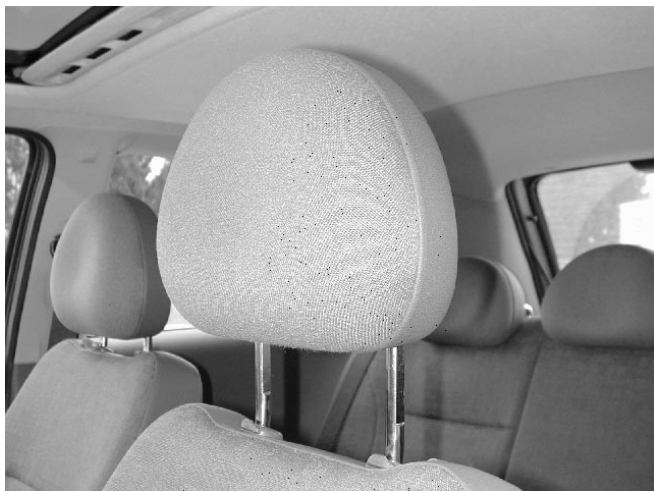
Die vorderen, "aktiven" Kopfstützen verringern beim Unfall mit Heckaufprall automatisch den horizontalen Abstand zum Kopf.
