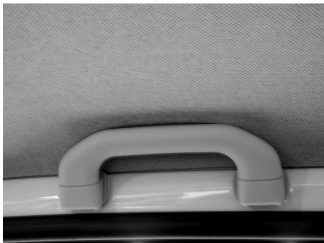
Nicht nur unverkleidete Blechprofile, sondern auch vorstehende Handgriffe bedrohen die Köpfe der Insassen.
