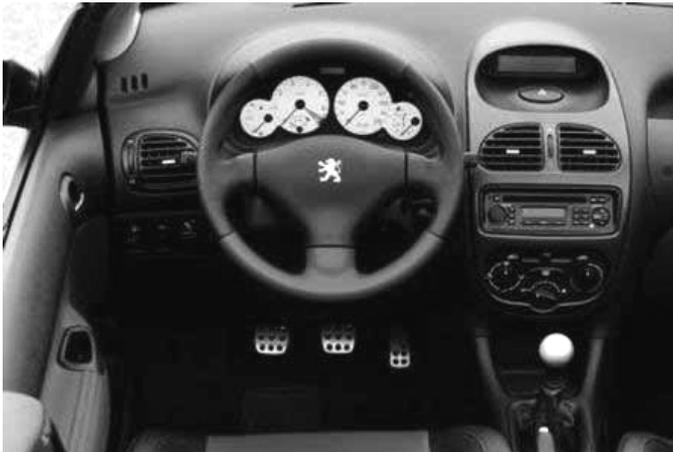
Die Bedienung für Heizung und Lüftung ist wie bei vielen Fahrzeugen zu tief, außerhalb des Sichtbereichs, angebracht. Gut ablesbar dagegen sind die großen, weiß hinterlegten Instrumente.
