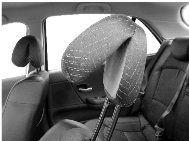
Die vorderen sehr hohen Kopfstützen sind durch Klappen horizontal anpassbar
