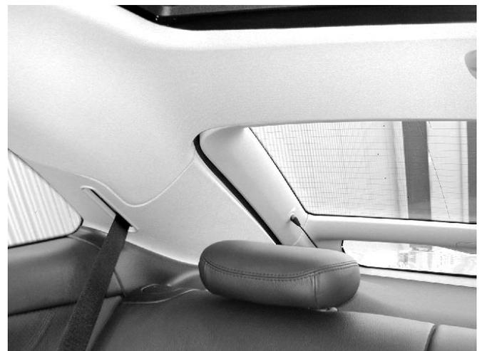
Die abklappbaren Kopfstützen verbessern die Sicht nach hinten.
