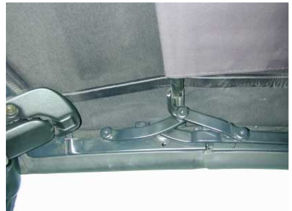
Das unverkleidete Verdeckgestänge erhöht die Verletzungsgefahr für Personen über 1,75 m Größe bei einem Seitenunfall.
