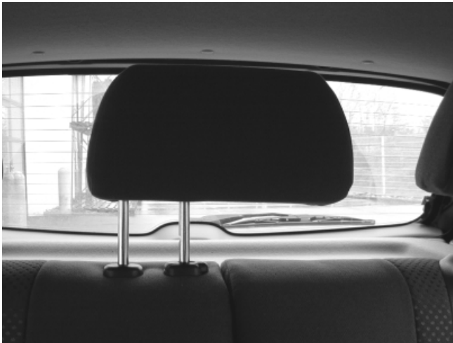
Die Mittelkopfstütze der Rücksitzbank ist durch die asymmetrische Halterung instabil.
