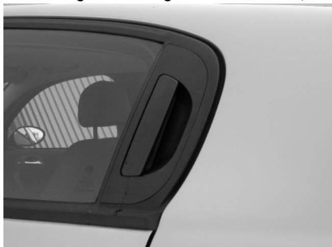
Wie beim größeren Bruder 156 sind die Griffe der hinteren Türen unauffällig im Türrahmen integriert.
