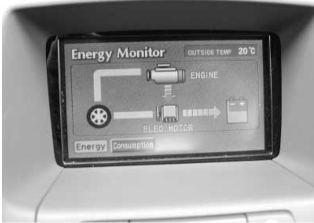
Das Display informiert über den Ladezustand der Batterie und wie die beiden Motoren gerade antreiben.
