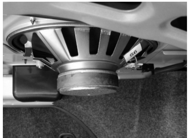
In den Kofferraum ragende Lautsprecher schränken die Nutzbarkeit ein
