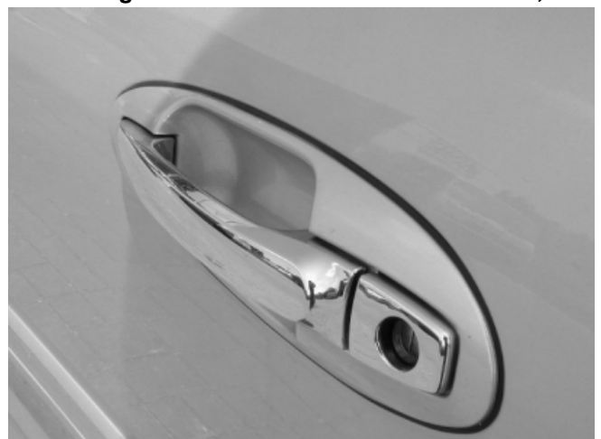
Zugfeste Griffe erleichtern das Öffnen verklemmter Türen bei einem Unfall.
