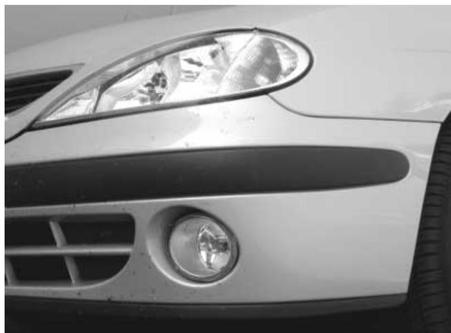
Die Stoßfänger sind überwiegend lackiert und kratzempfindlich. Im vorderen befinden sich bruchgefährdet die Nebelscheinwerfer.
