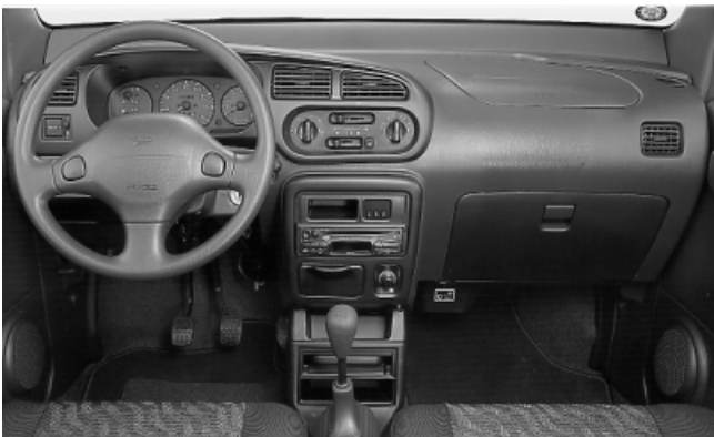
Wie bei vielen Fahrzeugen ist das Radio zu tief angeordnet.
