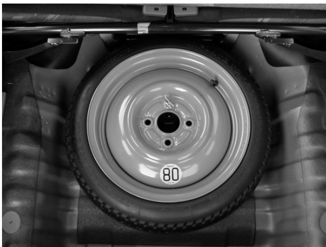
Das schmale Notrad erlaubt nur Fahrten mit einer Höchstgeschwindigkeit von 80 km/h
