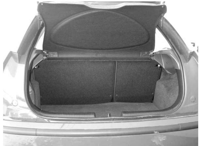
Mit 300 l Volumen liegt der Kofferraum im Durchschnitt der Fahrzeugklasse. Leider ist das Schloss der Heckklappe nicht in die Zentralverriegelung integriert.
