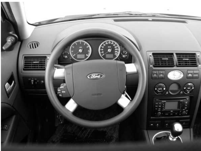
Sachlich präsentiert sich das Armaturenbrett des Mondeo. Neben einigen guten Lösungen gibt es auch Schwachpunkte in der Bedienung, wie z.B. das zu tief positionierte Radio.
