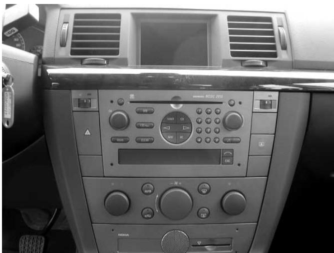
Während die Instrumente und das Display in der Mittelkonsole sehr gut im Blickfeld liegen, sind die Bedienelemente für Heizung und Lüftung wegen der geringen Größe und der tiefen Lage leicht zu verwechseln.
