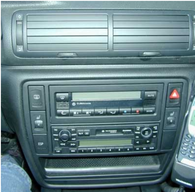
Das Radio ist zu tief platziert. Das ist heute bei vielen Fahrzeugen ein weit verbreitetes Problem.
