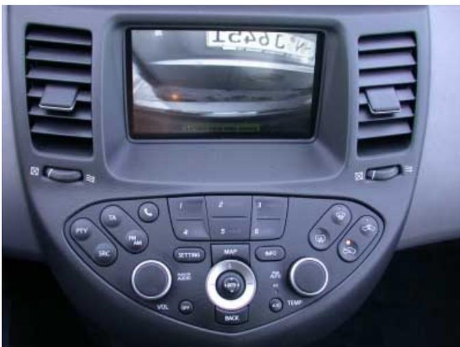
Mit Einlegen des Rückwärtsganges zeigt der Monitor automatisch den rückwärtigen Bereich - eine sehr gute Lösung.
