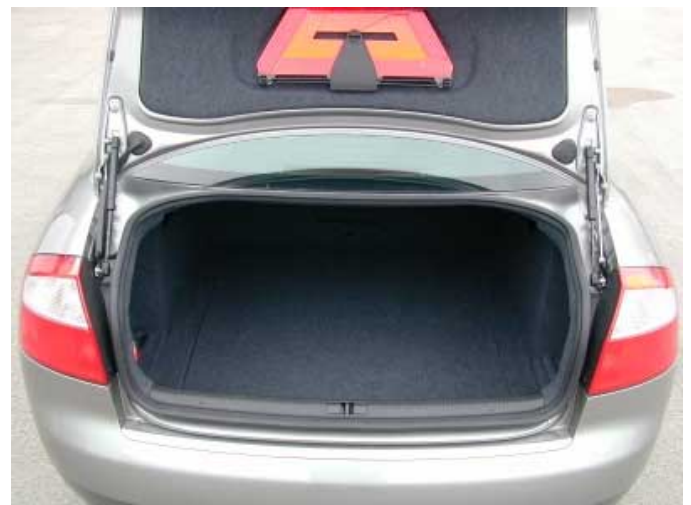
Zwar ist der Kofferraum verhältnismäßig groß, kann aber wegen der schmalen Öffnung nur schwer be- und entladen werden.
