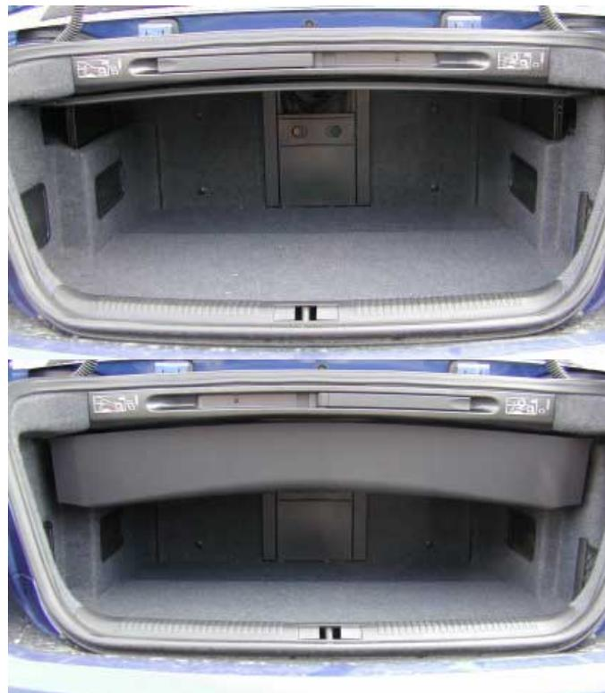
295l fasst das Kofferraumabteil bei geschlossenem Dach. Fährt man "oben ohne", stehen 50l weniger zur Verfügung.
