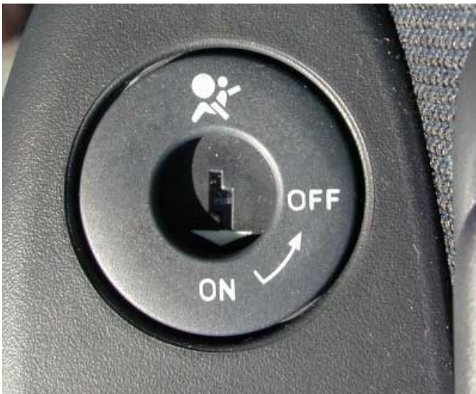
Die Beifahrerairbags lassen sich per Zündschlüssel deaktivieren. Damit können auch auf diesem Sitzplatz rückwärtsgerichtete Kinderrückhaltesysteme verwendet werden.
