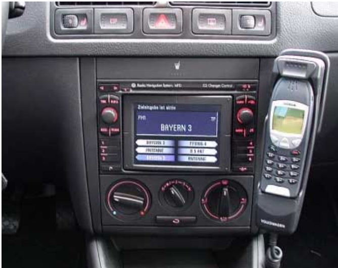
Das Display in der Mittelkonsole ist zu tief angeordnet und lenkt damit den Blick des Fahrers vom Verkehrsgeschehen ab.
