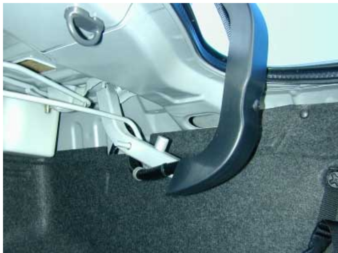
Die nicht mehr zeitgemäßen Haltebügel der Kofferraumklappe schränken die Nutzbarkeit ein.
