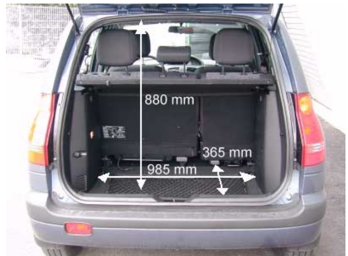
Zur Vergrößerung des Kofferraums kann die Rücksitzbank längs verschoben werden.
