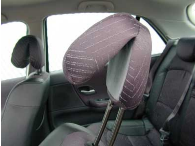
Die Kopfstützen der Vordersitze sind zwar ausreichend hoch einstellbar, dann jedoch nur ungenügend fixierbar.
