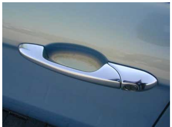
Die "zugfesten" Bügelgriffe erleichtern das Öffnen der Türen nach einem Unfall.
