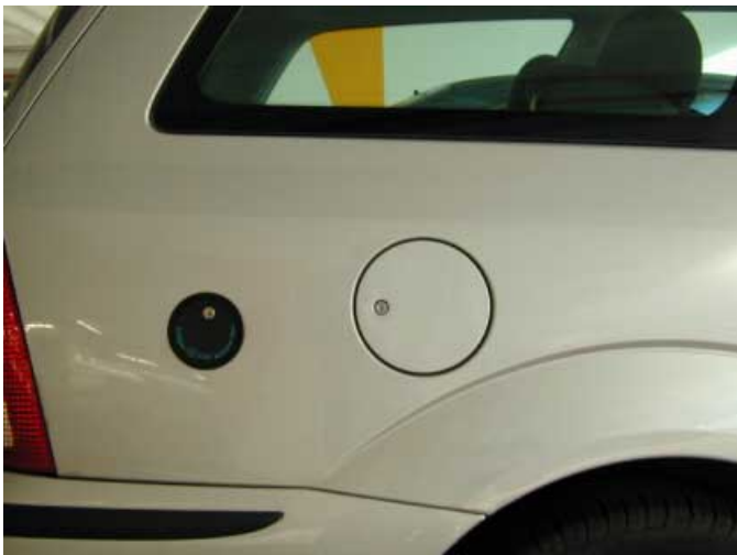
Der Einfüllstutzen für den Gastank ist nicht in die Tankklappe integriert und muss per Schlüssel entriegelt werden.
