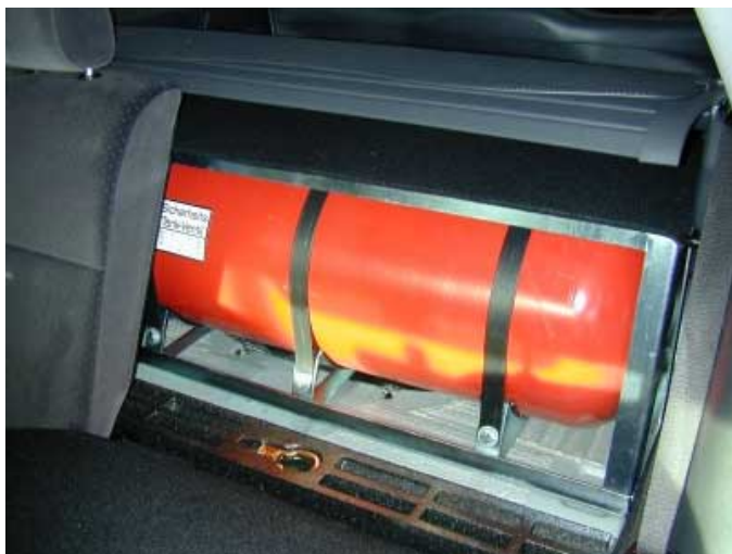
Der Gastank ist hinter der Rücksitzlehne positioniert und schränkt damit nicht nur das Kofferraumvolumen gegenüber einem "normalen" Focus Turnier um ca. 220l ein, auch die Variabilität leidet darunter.
