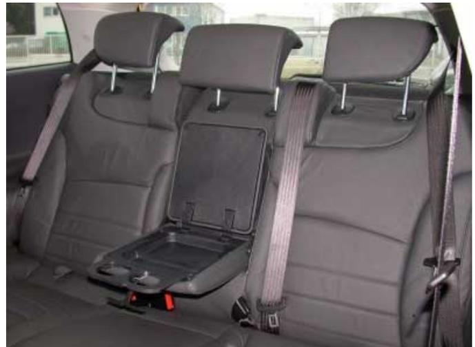
Eine Durchladeluke ermöglicht den Transport langer Gegenstände.
