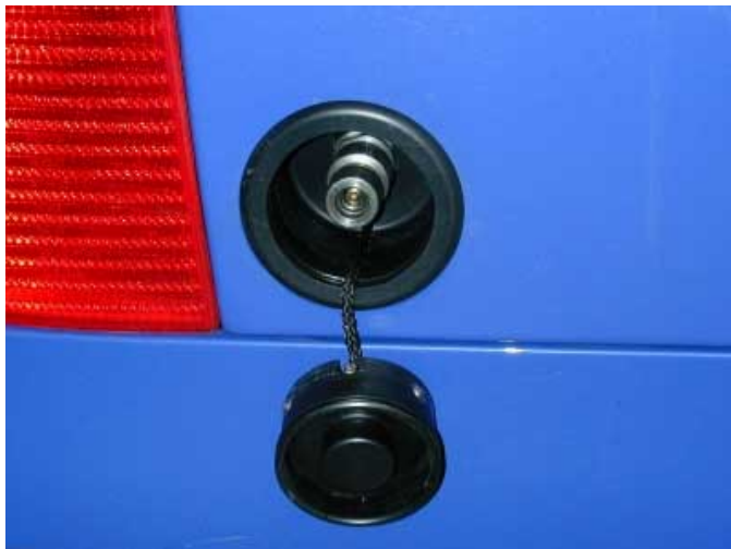
Der Einfüllstutzen der Gastanks ist separat untergebracht und nicht abschließbar.
