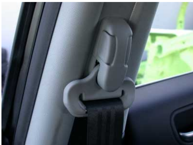
Nicht dem Stand der Sicherheitstechnik entsprechen die vorstehenden, kantigen Gurtbeschläge in Kopfnähe.
