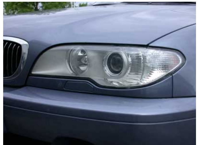
Als eines der ersten Fahrzeuge überhaupt verfügt das faceliftete 3er Cabrio über ein aufpreispflichtiges Kurvenlicht.
