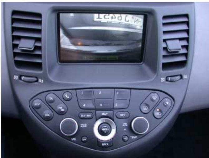
Mit Einlegen des Rückwärtsganges zeigt der Monitor automatisch den rückwärtigen Bereich – Parkensoren wären besser.
