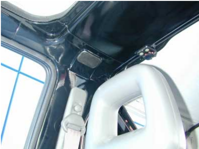
Unverkleidete Blechprofile und harte, vorstehende Gurtbeschläge erhöhen das Verletzungsrisiko bei einem Unfall.
