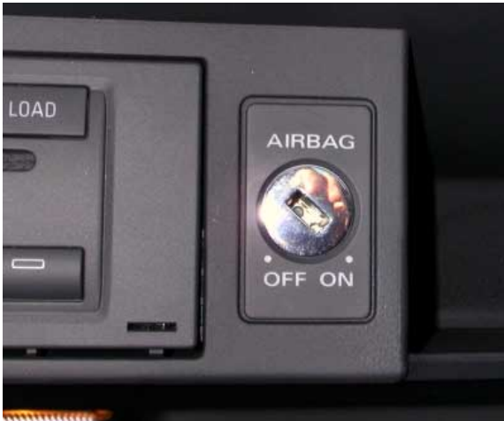
Die Beifahrerairbags lassen sich per Zündschlüssel deaktivieren. Damit können auch auf diesem Platz rückwärtsgerichtete Kinderrückhaltesysteme verwendet werden.
