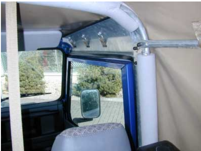
Die Schutzpolsterungen um die Verdeckkonstruktion stammen aus dem Baumarkt und waren ursprünglich dazu vorgesehen, Heizungsrohre zu isolieren.
