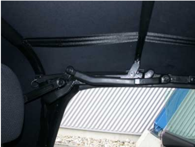
Das unverkleidete Dachgestänge erhöht das Verletzungsrisiko bei einem Unfall
