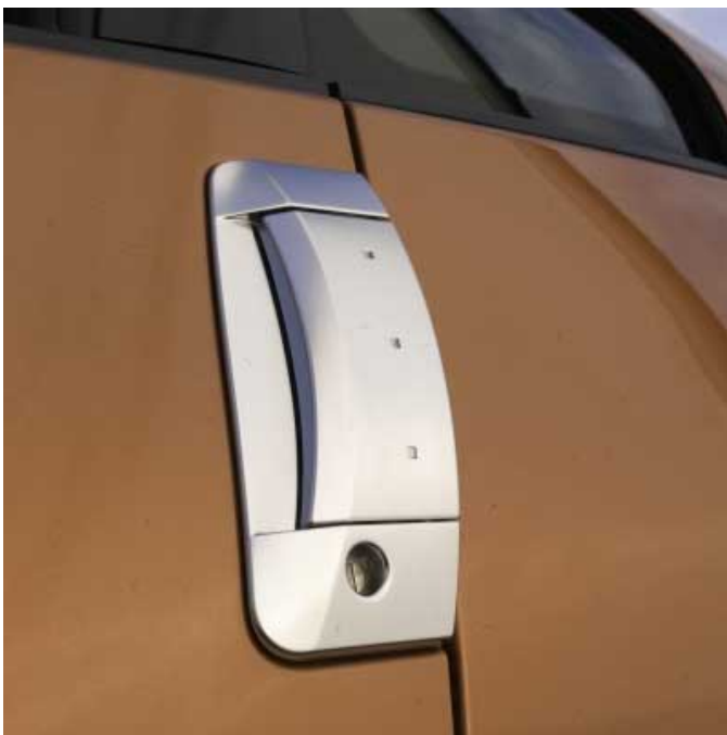
An den Klapp-Türgriffen lässt sich zu wenig Zugkraft aufbringen, um nach einem Unfall verklemt Türen zu öffnen.
