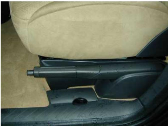
Links vom Fahrersitz ist die Handbremse angebracht. Damit kann sie in einer Gefahrensituation vom Beifahrer nicht erreicht werden.
