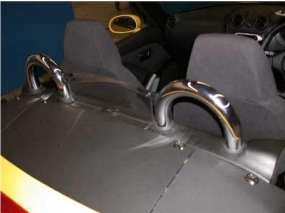
Hinter den Sitzen befinden sich Überrollbügel, die aufgrund der geringen Bauhöhe eine eher optische Funktion haben, bei einem Überschlag jedoch nur eingeschränktes Schutzpotential darstellen.
