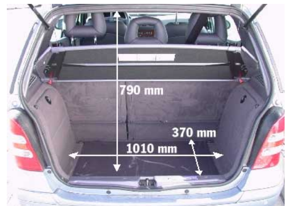
Das konzeptbedingte, knappe Kofferraumvolumen wird durch die einzigartige Variabilität mehr als ausgeglichen. Vom längeren Radstand des LR profitiert der Kofferraum indes nicht.
