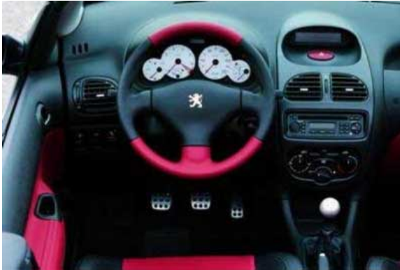
Die Regler für Heizung und Lüftung sind wie bei vielen Fahrzeugen zu tief, außerhalb des Sichtbereichs, angebracht. Gut ablesbar dagegen sind die großen, weiß hinterlegten Instrumente.
