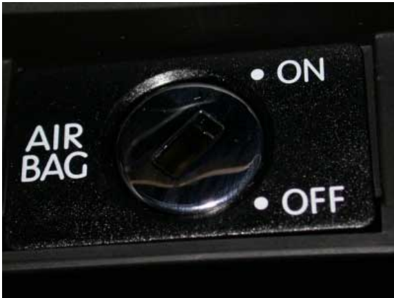
Neu beim Golf V sind die per Zündschlüssel abschaltbaren Airbags des Beifahrersitzes. Damit können auch auf diesem Sitzplatz rückwärtsgerichtete Kindersitze verwendet werden.
