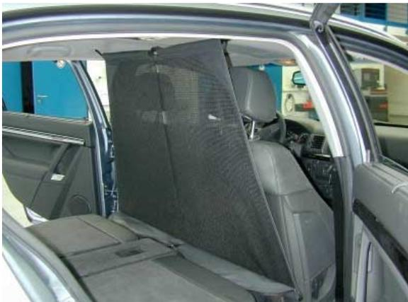
Eine sinnvolle Lösung ist das auch bei umgeklappten Sitzen bis zur Decke reichende Trennnetz.
