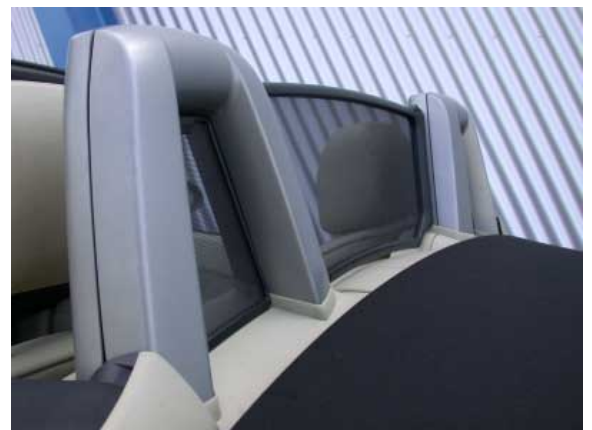
Der Z4 ist mit stabilen Überrollbügeln ausgestattet. Versuche haben gezeigt, daß solche Bügel die Insassen bei einem Überschlag wirksam schützen können.
